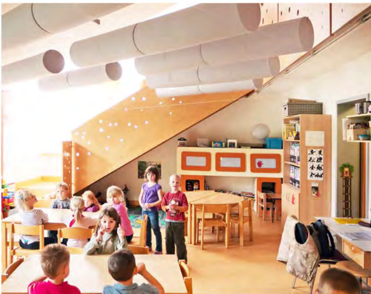
AGORAsolution: Abgehängte Absorber aus AGORApipes und an die Wand montierte Akustikelemente aus AGORAforms.
