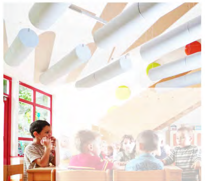
AGORAsolution: Abgehängte Absorber aus AGORApipes und an die Wand montierte Akustikelemente aus AGORAforms.
